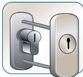
Schutzrosette mit Bohr- und Ziehschutz
